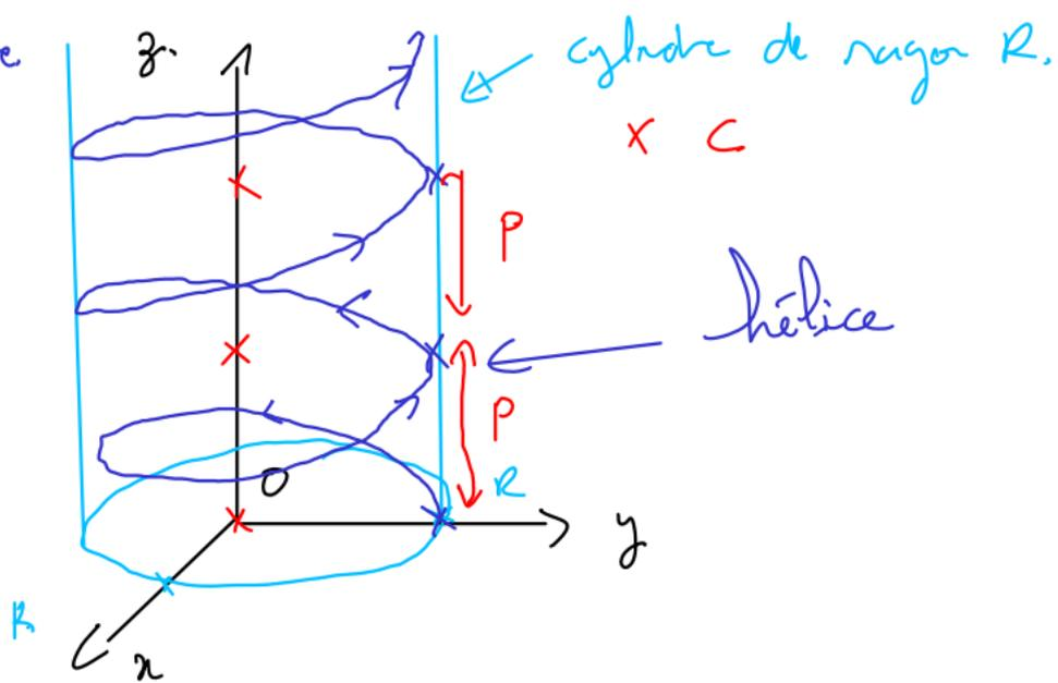
4/ Pas  $p$  de l'hélice : distance parcourue suivant l'axe de l'hélice ( $Oz$ ) pendant la durée  $T$  d'un tour. ( $\Delta\theta = 2\pi$ )
